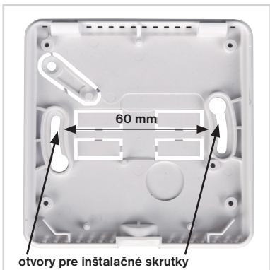
Obr.3 Pripevnite zadnú časť snímača na stenu.
