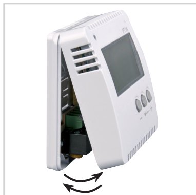
Obr.4 Nasadíte diel s elektronikou na spodnú časť a zaistíte aretačnou skrutkou.
