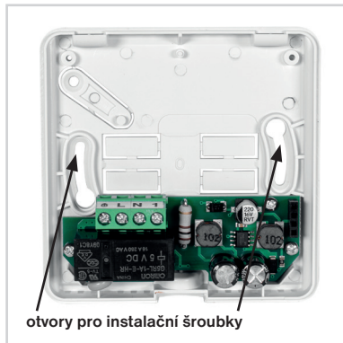
Obr.4 Nasadíte diel s elektronikou na spodnú časť a zaistíte aretačnou skrutkou.
