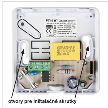
Obr.4 Nasadíte diel s elektronikou na spodnú časť a zaistíte poistnou skrutkou.
