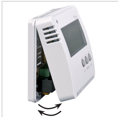
Obr.4 Nasadíte diel s elektronikou na spodnú časť a zaistíte poistnou skrutkou.
