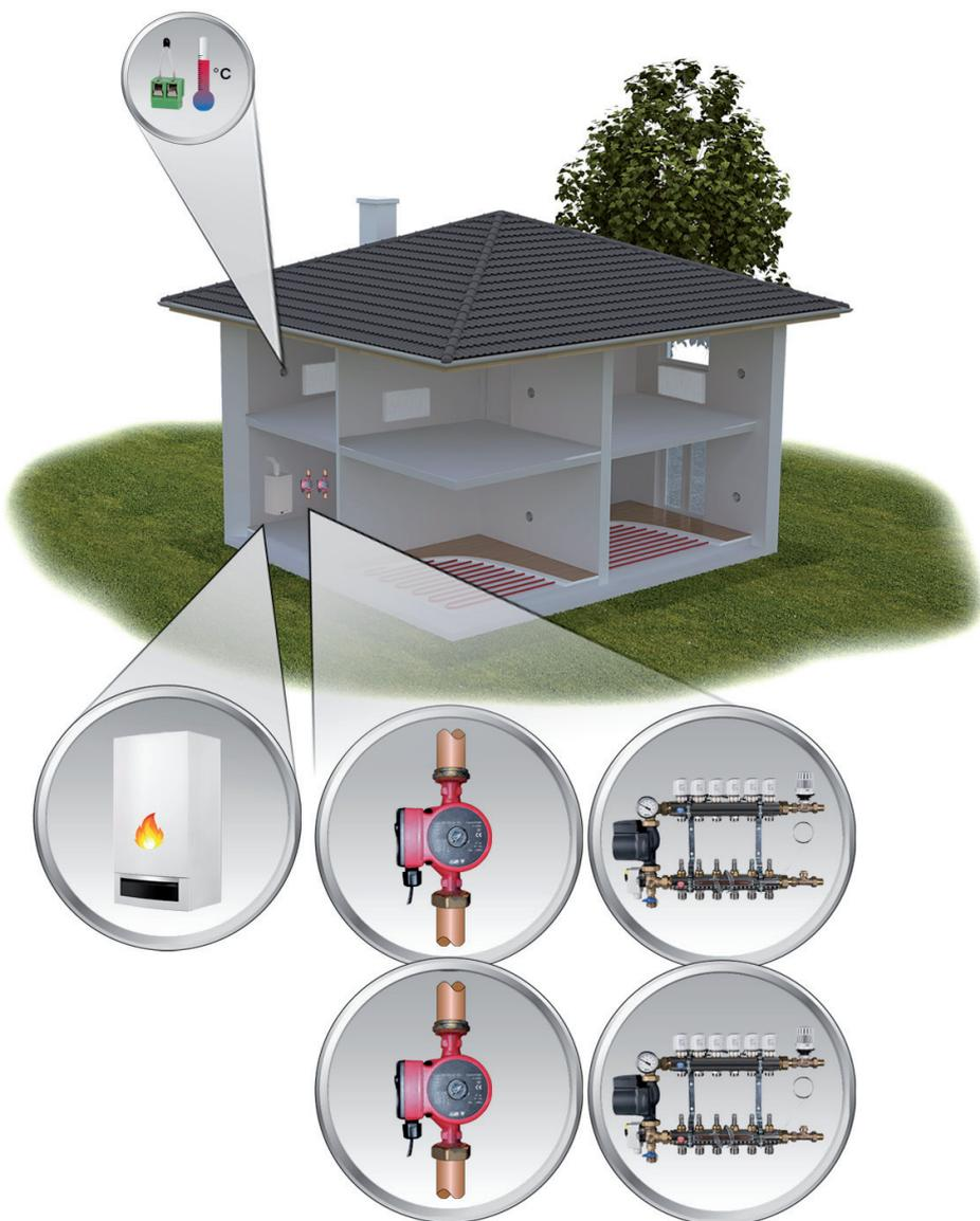
Pro vícegenerační domy. Dvě čerpadla umožňují cirkulaci topné vody v daném patře. Každá jednotka PT41-M ovládá kotel, příslušné čerpadlo a dalších 6 zón. Pro správnou funkci je nutné v ovládacím softwaru zaškrtnout volbu funkce: **Spínání čerpadla pouze podle aktuální jednotky.**
