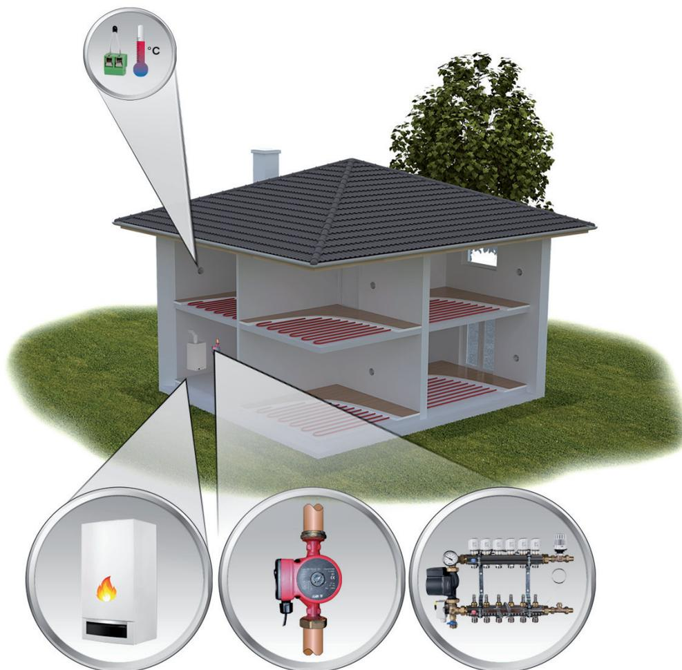
Jednotka PT41-M ovládá kotel a čerpadlo a dalších 6 zón. V případě většího počtu zón je možné připojit další max.3 jednotky PT41-S (každá jednotka může ovládat dalších 8 zón). Při požadavku na topení od kterékoli zóny dojde k otevření ventilu dané zóny a sepnutí kotle a čerpadla.
